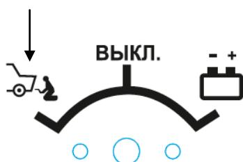
**Внимание:** Время каждого запуска составляет 3 секунды. Второй запуск следует производить через 120 секунд. Можно выполнить до пяти запусков. Если двигатель запускался непрерывно, необходимо сделать перерыв между запусками 10 минут, чтобы трансформатор внутри изделия остыл для повторного запуска двигателя.
