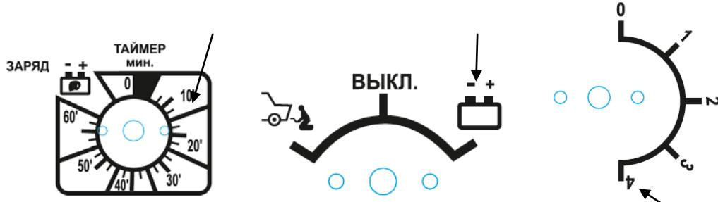
**При Запуске:** Переключатель режимов Зарядка/ Пуск поставить в положение Пуск. При этом одновременно необходимо повернуть Ключ в замке зажигания автомобиля.
