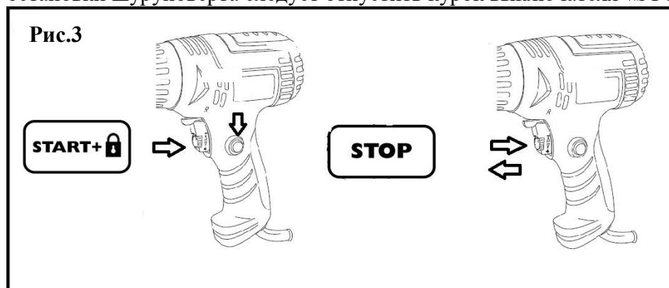
5.2. Шуруповёрт оборудован кнопкой фиксации максимальных оборотов(2) расположенной сбоку рукоятки управления рядом с выключателем(1)(рис.3). Для фиксации оборотов необходимо нажать на курок выключателя(1)и зафиксировать его с помощью кнопки фиксации(2). Для разблокировки и остановки необходимо однократно нажать и отпустить курок выключателя(1).
