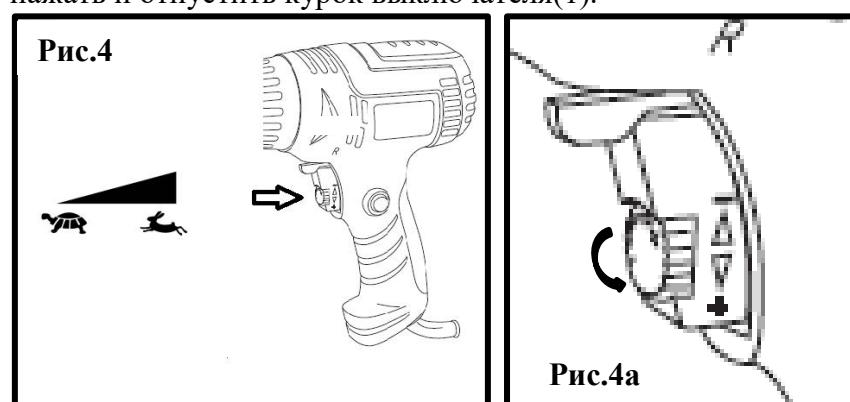
5.3. Число оборотов увеличивается с увеличением усилия на выключатель (регулировка оборотов от нажатия), а также с помощью регулятора числа оборотов установленного на выключателе (рис.4 и 4а).
