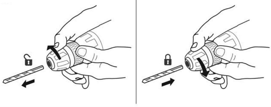
5.5. Для удобства быстрой смены насадок, шуруповёрт оснащён 2х муфтовым быстрозажимным патроном (БЗП), фиксирующим насадки без дополнительных приспособлений. Для установки и фиксации насадок необходимо одной рукой удерживать неподвижную часть патрона, а второй рукой закручивать или раскручивать подвижную часть патрона (рис.6).
