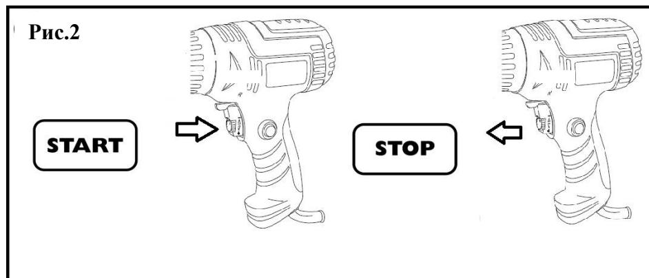
5.1. Для запуска шуруповётра необходимо нажать на курок выключатель «START». Для остановки шуруповёрта следует отпустить курок выключателя «STOP»(рис.2).
