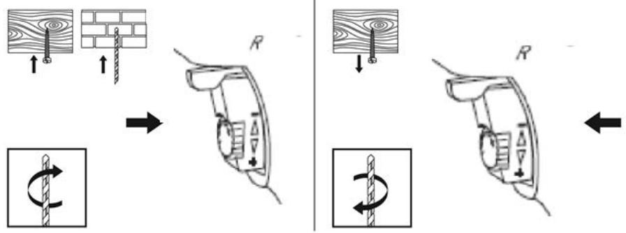
5.4. Для заворачивания/выворачивания шурупов, а также при заклинивании сверла во время сверления, шуруповёрт оборудован переключателем реверса регулирующим направление вращения (вправо/влево) (рис.5).
