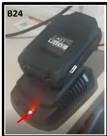
• **Немигающий КРАСНЫЙ индикатор на зарядном устройстве** указывает, что зарядное устройство начало цикл зарядки (Рис.В24).
