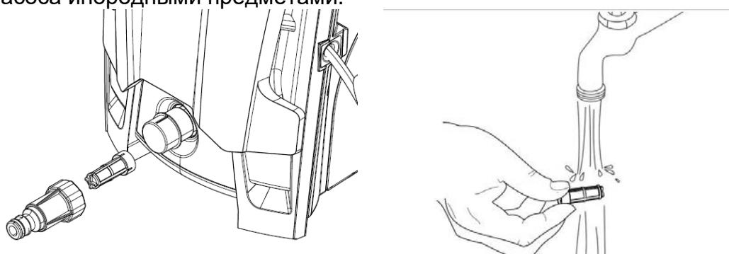
Очистите форсунки при помощи входящей в комплект иглы. Снимите с пистолета распылитель. Удалите загрязнение из отверстия форсунки и сполосните.
