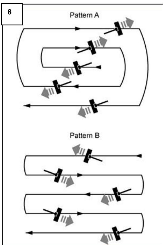
На больших площадях требуется определенная схема работы для тщательной очистки участка от снега. Эти схемы позволят избежать разбрасывания снега в нежелательных местах, а также исключить повторную уборку снега (Рис. 8).
