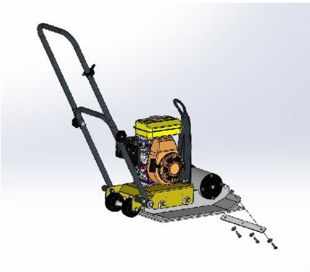
Закрепите коврик на виброплите, как показано на рисунке. Совместите отверстия в виброплите, коврике и прижимных пластинах. Закрепите коврик с помощью стопорных шайб 10 и болтов M10x30.
