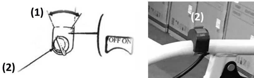
Выключатель двигателя на рукоятке управления.
