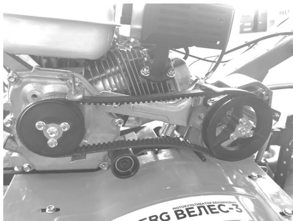
Для того чтобы произвести регулировку необходимо отпустить четыре установочных болта. Переместите двигатель вперед или назад, чтобы отрегулировать соответствующую натяжку.
