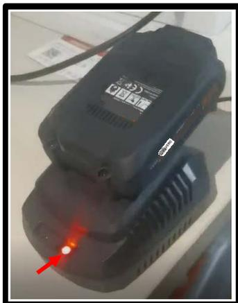
• **Немигающий КРАСНЫЙ индикатор на зарядном устройстве** указывает, что зарядное устройство начало цикл зарядки (Рис.12).
