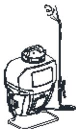
Перед началом эксплуатации требуется произвести пробное распыление чистой водой, проверить соединения на предмет возможной утечки и проверить условия распыления. Перед приготовлением химической жидкости убедитесь, что все в порядке.
