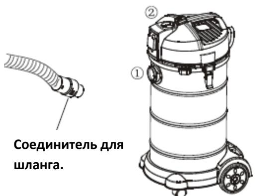
Установите соединитель для шланга в **положение 1** – включается работа в режиме всасывания.
