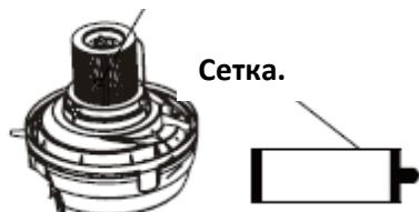
Извлеките сетку из высокоэффективного воздушного фильтра (HEPA).
