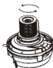
Поверните стопорное кольцо против часовой стрелки, извлеките фильтры.
